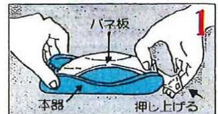
左手で本器を持ち、右手を図のようにあて、右手の3本指で下から押し上げるようにして曲げる。
